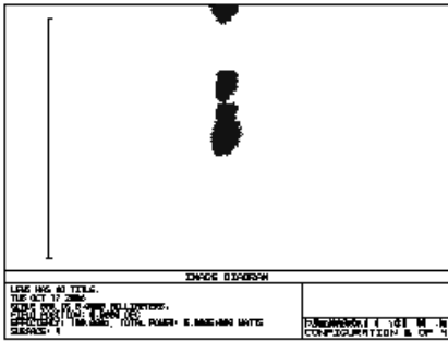
图 5 普通望远物镜几何模拟像
